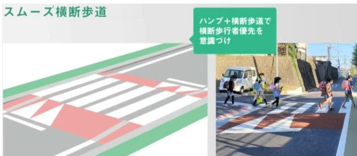
※2 「ハンプ」…車両の通行速度の高い生活道路において、路面にハンプ（凸部）を設置することで、速度の抑制を図るものです。
