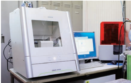
データはこちらの機械へと送られ、義歯やスプリットなどの製品の基本が作られる 左：歯科用ミリングマシン 右：歯科用3Dプリンター
